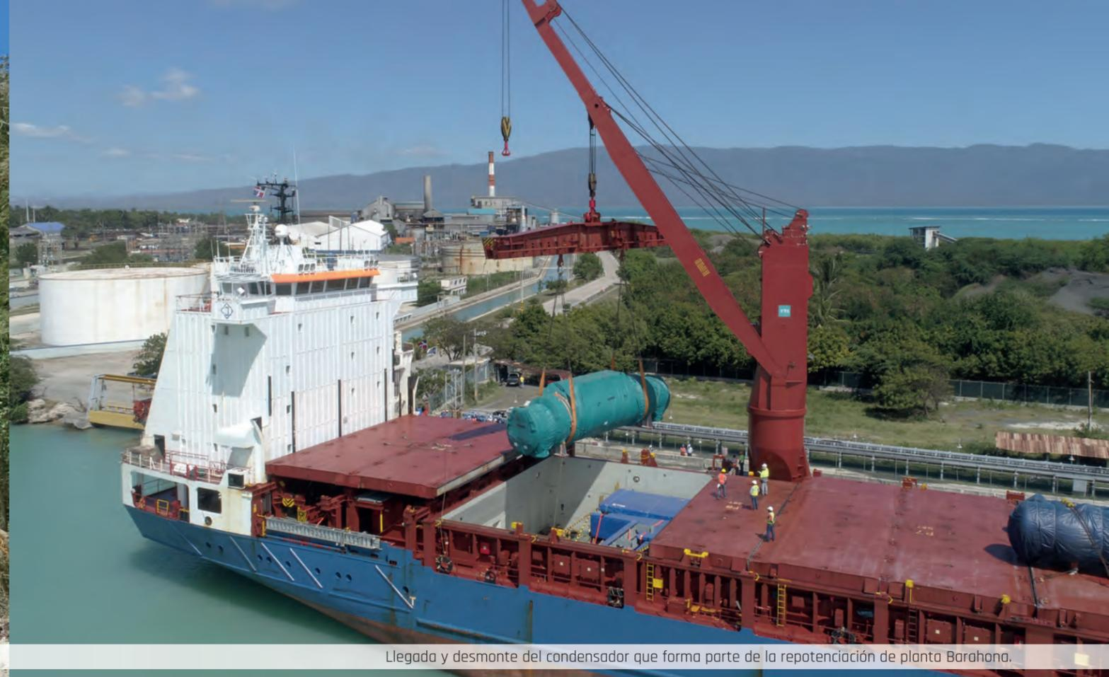
Llegada y desmonte del condensador que forma parte de la repotenciación de planta Barahona.
